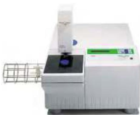
**Fig. 3.11.** Equipo de termogravimetría Metler Toledo, mod. 851e.
