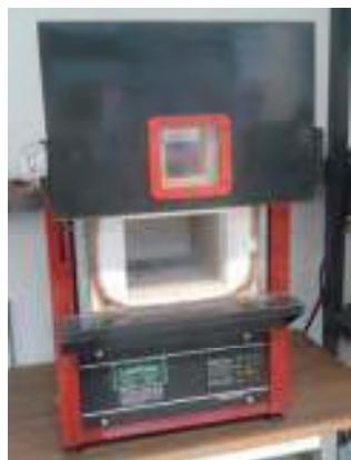
**Fig. 3.5.** Mufla Vecstar Ltd, mod. LF2SP empleada para la fabricación de las espumas.
