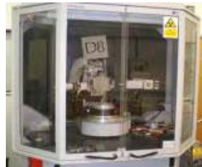
**Fig. 3.15.** Difractómetro de rayos X Bruker, D8 Discover.
