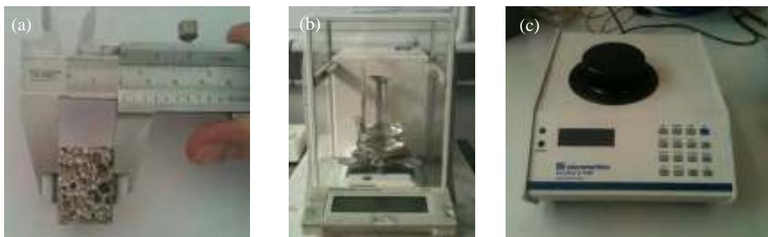
**Fig. 3.12.** Instrumentos empleados en la determinación del volumen y densidad de las muestras estudiadas. (a) Pie de rey (b) balanza Mettler, mod. AT261, dotada de un kit de medida de densidad por método de Arquímedes (c) Picnómetro Accupyc 1340 (Micromeritics).
